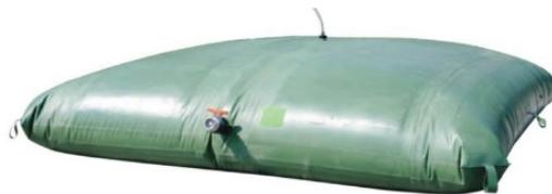
Unsere Kissentanks werden aus hochwertigen, NBR/PVC-beschichteten Polyestergeweben gefertigt, so dass eine hohe Dauerbeständigkeit gegen Mineralöle und Chemikalien gewährleistet ist. Sie sind, je nach Baugröße, mit mindestens je einem Füll- und einem Entlüftungsstutzen ausgerüstet. Andere, kundenspezifische Ausrüstungen sind möglich, da die Behälter auftragsbezogen angefertigt werden.
