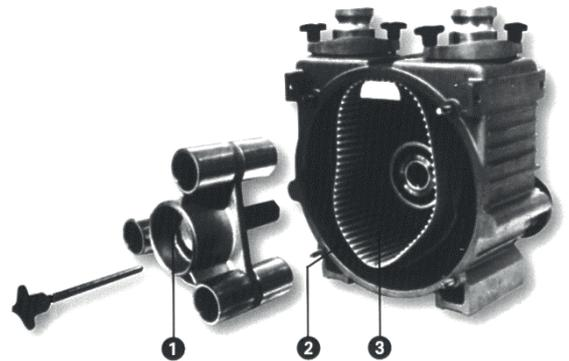
Das flüssigkeitsdichte Pumpengehäuse enthält Glycerin oder Silikon, welches zur Schmierung, Dichtung und Kühlung dient. Ein an die Saugseite angeschlossenes Manometer zeigt die Saugleistung der Pumpe an.
