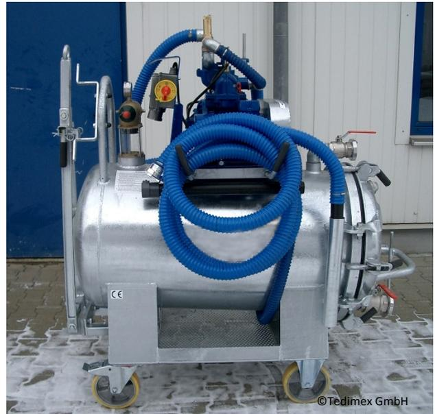
Der hintere ist schnell mittels Exzenterhebeln u. Hackenschrauben zu öffnen und komplett seitlich ausschwenkbar. Daran angebracht sind Gewindestutzen mit 2" Kugelhahn und Storz-C-Kupplung zur Entleerung bzw. zum Anschluss des Ablaufschlauchs.
