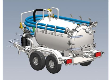
Zum Lieferumfang gehören 10,0 m hochflexibler, druck- und vakuumfester Förderschlauch NW 50 mit Storz-Kupplung und im Schlauch eingebunden PVC-Sauglanze ca. 1,3 m lang.
