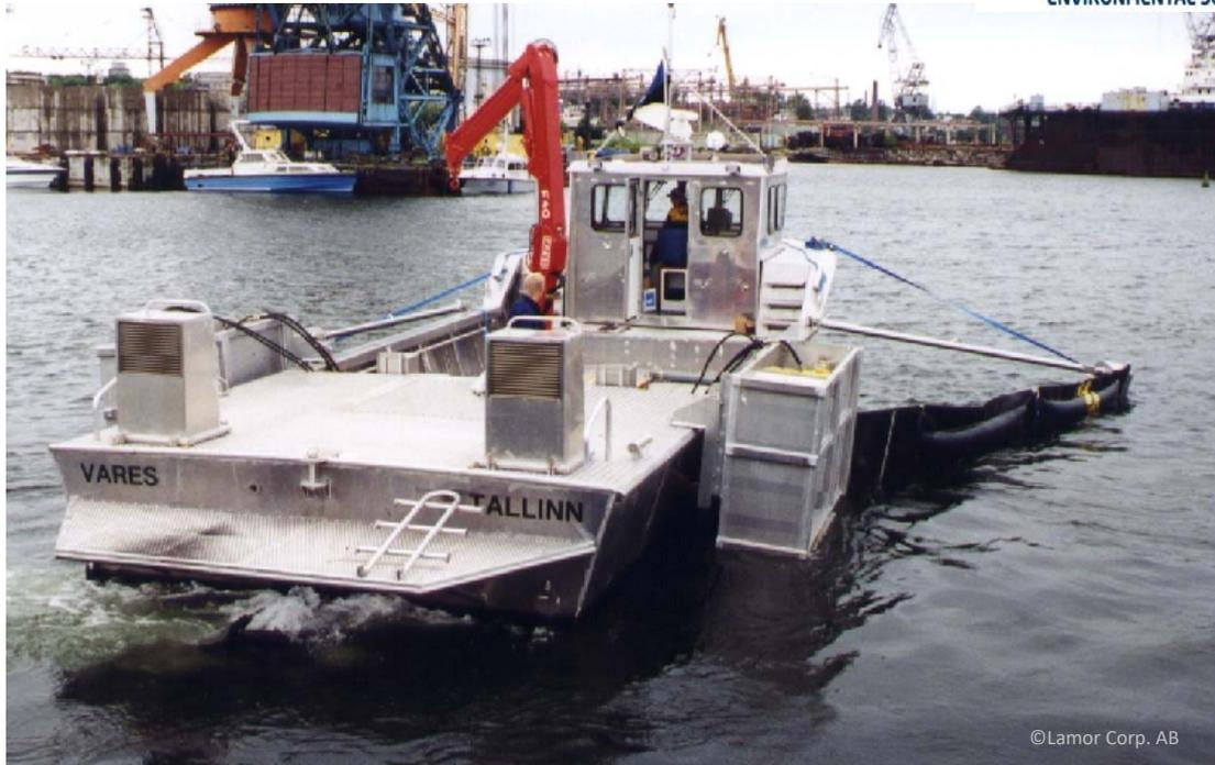
**LAMOR SIDE COLLECTOR Systeme** sind betriebsfertige Kassetten, die das Bürstensystem und die Förderpumpe enthalten. Sie können mit Wasserfahrzeugen nahezu jeder Größe betrieben werden. Das Fahrzeug steht dadurch kurzfristig für Ölbekämpfungsaufgaben bereit, ohne in seinen alltäglichen Aufgaben behindert oder eingeschränkt zu werden !
