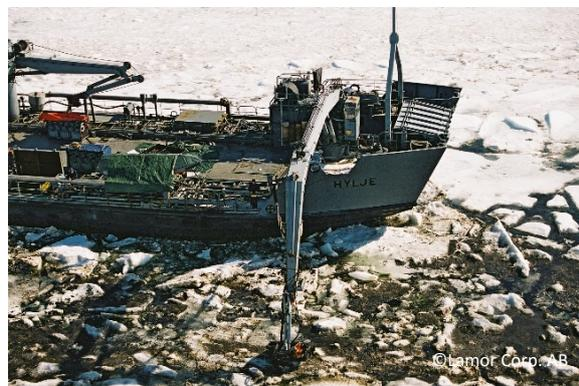
Die Montage erfolgt wie der normale Austausch eines Baggerlöffels. Für die Bedienung ist nur eine kurze Einweisung erforderlich.
