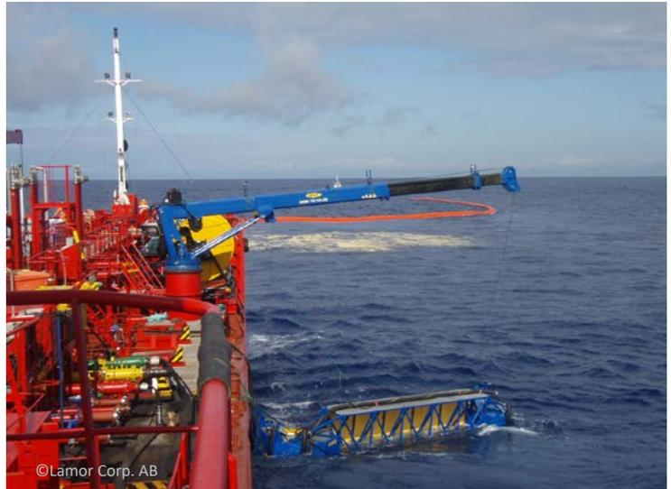
Vorteil der Kombination aus Bürstenskimmer und Sweepingarm ist, dass der Wasseranteil der aufgenommenen Phase von gewöhnlich 90% auf circa 10% reduziert wird.
