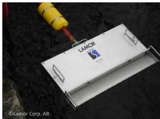
Der SLURP-Ölskimmer zeichnet sich besonders dadurch aus, dass er keine beweglichen Teile hat. Das Eintauchen des Wehrs wird ausschliesslich über die Förderleistung der Pumpe geregelt; der Skimmer verfügt über keine beweglichen Teile.
