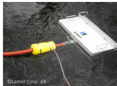
SLURP-Skimmer werden speziell dort eingesetzt, wo extrem hohe Flussraten wichtig sind. Die Korrosionsbeständigkeit des Edelstahls macht ihn für die Chemie- und der Lebensmittel-Industrie interessant.
