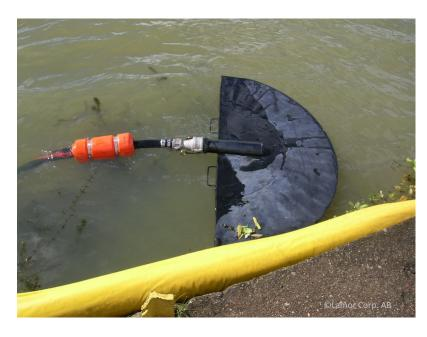
Der Rigid Manta Ray ist ein spezieller Wehrskimmer für geringe Ölschichtstärken und Einsätze auf ruhigen Gewässern, z.B. auf Seen und Absetzbecken. Er ist unempfindlich gegen natürliches Treibgut wie Laub oder Gras und kann mit unterschiedlichen Vakuumquellen betrieben werden!
