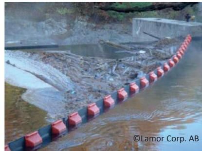
Die Schwimmkörper der PFB Mk 8 Ölsperre bestehen aus geschlossenzellig extrudiertem Polyethylen-Schaum, der in einem speziellen Heiss-Pressverfahren eine feste Aussenschicht erhält. Die Schwimmeroberkante wird dabei als Griffleiste zur leichteren Handhabung ausgebildet. Die verwendeten Werkstoffe sind resistent gegen Ultraviolett-Strahlung und Algenbewuchs.
